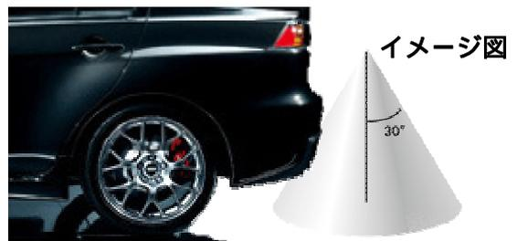
フロア・ラインとは、垂直軸と母線のなす角度が30°である円錐を、積載状態にある自動車の外部表面に、できるだけ低い位置で連続的に接触させたときの自動車の外部表面と円錐との接点の幾何学的軌跡。
